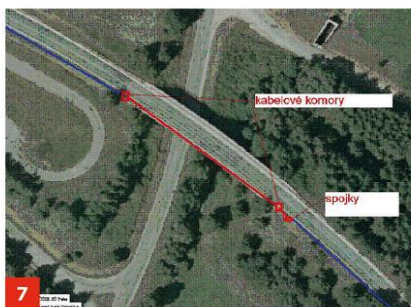
Obr. 7 – Schéma řešení při pokládání chrániček pro optické kabely nedaleko obce Kozlov na Vysočině Krajský úřad Kraje Vysočina
