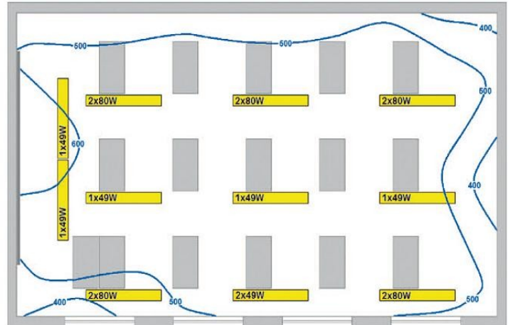
Obr. 5 – Příklad osvětlení klasické třídy; svítidla různých příkonů jsou zvolena tak, aby byla zajištěna co nejúsporněji požadovaná osvětlenost při co nejvyšší rovnoměrnosti osvětlení.
