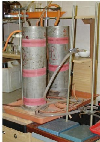
Obr. 1 a 2 – Stanovení hydraulické vodivosti ve vertikálním a horizontálním směru
