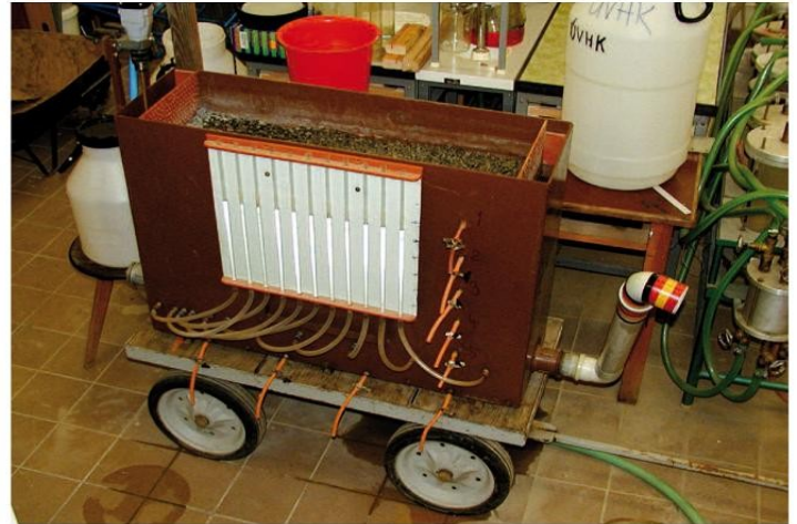
Obr. 1 a 2 – Stanovení hydraulické vodivosti ve vertikálním a horizontálním směru
