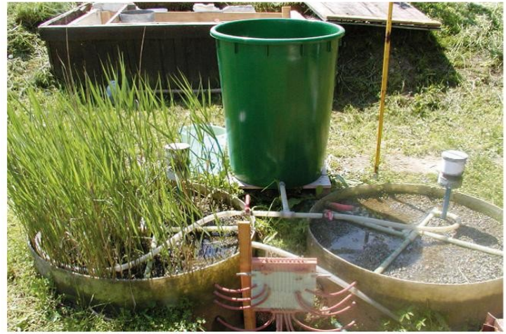
Obr. 4 – Poloprovozní terénní model zemního filtru s vegetací a bez vegetace
