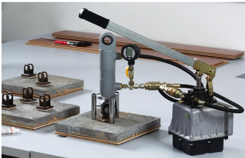
Obr. 2 – Současná sestava pro měření přídržnosti
