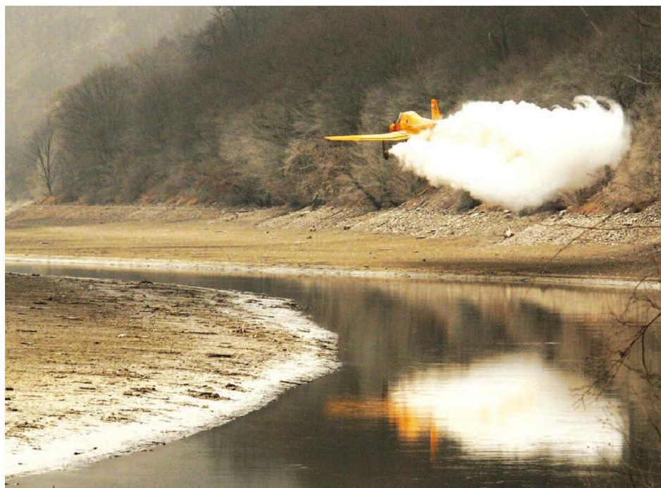
Obr. 3 – Snaha o revitalizační zásah na údolní nádrži Brno – vápnění dna při snížené hladině
