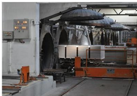
Obr. 5 Behringersdorf (D) – autoklávy v podniku Zapf Daigfuss sloužící výrobě vápenopískového materiálu Foto: Josef Chybík
