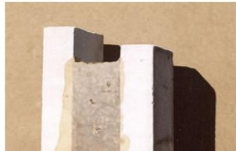
Obr. 14 – Betonové dílce spojené vytvrzeným polymerem
