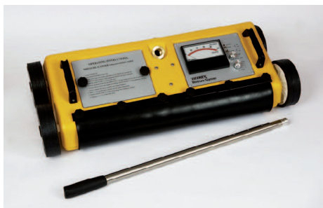
Obr. 1 – Přístroj Dec Scanner pro nedestruktivní indukční defektoskopii
