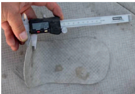
Obr. 10 – Při měření tloušťky odebraného vzorku byla zjištěna tloušťka 1,05 mm
