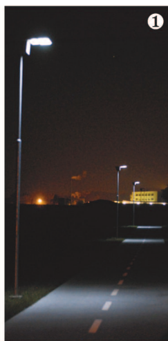
Obr. 1 - Svítidlo s vysokým činitelem využití, avšak nevyužitelné, protože veškeré světlo směřuje pouze pod sebe. Osm metrů od svítidla byla osvětlenost v desetinách luxu. Celkem slušná tma.
