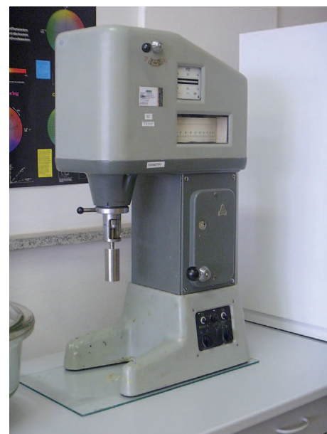
Obr. 4 – Vnitřní rotující válec v tělese rotačního viskozimetru a rotační viskozimetr
