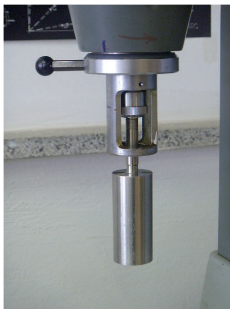
Obr. 4 – Vnitřní rotující válec v tělese rotačního viskozimetru a rotační viskozimetr
