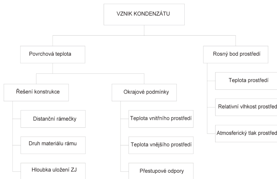
Obrázek č. 1 blokové schéma prvků ovlivňujících vznik kondenzace vodních par.
