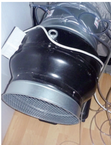
5 - Meranie vzduchovej priepustnosti budovy (alt. prievzdušnosti okien)
