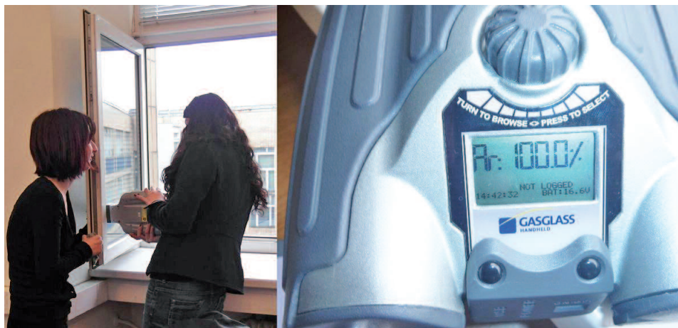
1 – Nedeštruktívne meranie % naplnenia izolačného dvojskla plynom
